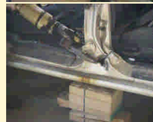
Einsatz der Rettungsschere, durchtrennen der B-Säule
