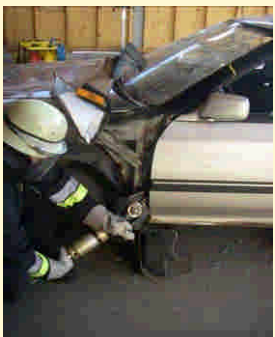
Abtrennen der Fahrertür durch Schneiden
